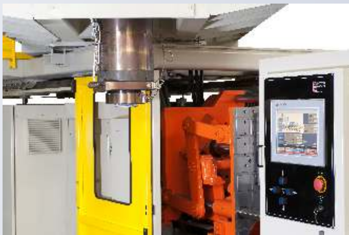
Detalhe do manipulador para extração automática lateral do produto
