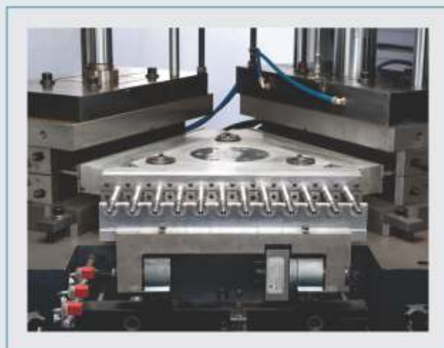
Estação de extração
